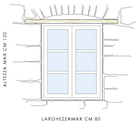
FINESTRA CON ARCHITRAVE CON VOLTINA IN MURATURA E TAVOLA IN LEGNO
